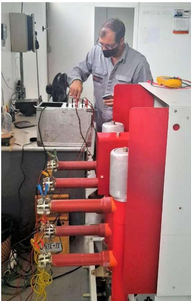
Calibração dos relés de proteção dos motores da EB-1
